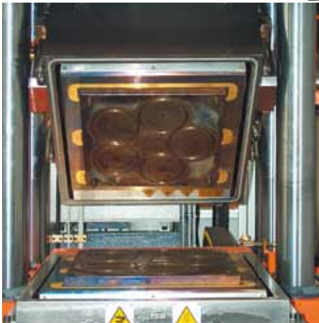
M-TECS 240-G rubberpers met vacuümkamer.
