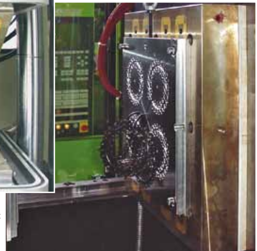
M-TECS 240-G magneet-verwarmingsplaat op een elastomeermachine – volledige magneetkracht brengt volledig contact en verbeterde temperatuurhomogeniteit.
