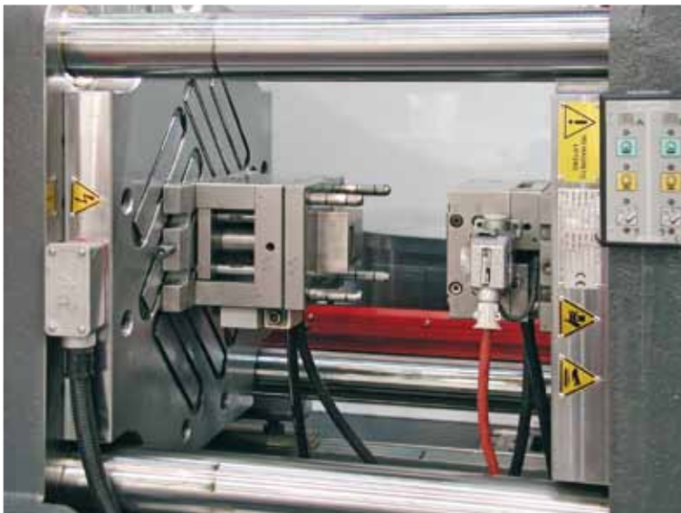
Ook kleine gereedschappen worden veilig opgespannen. De langpoolconcentratie leidt tot maximale magneetkracht in de gereedschap grondplaat. Machine FM110 Electra, magneetkracht 8 ton.
