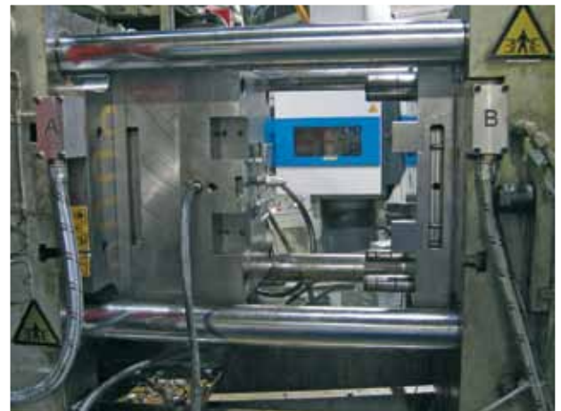
Magneet-spansysteem op een URPE drukgietmachine CC125, sluitkracht 1500 kN, magneetkracht 110 kN, temperatuurbereik 230 graden C.
