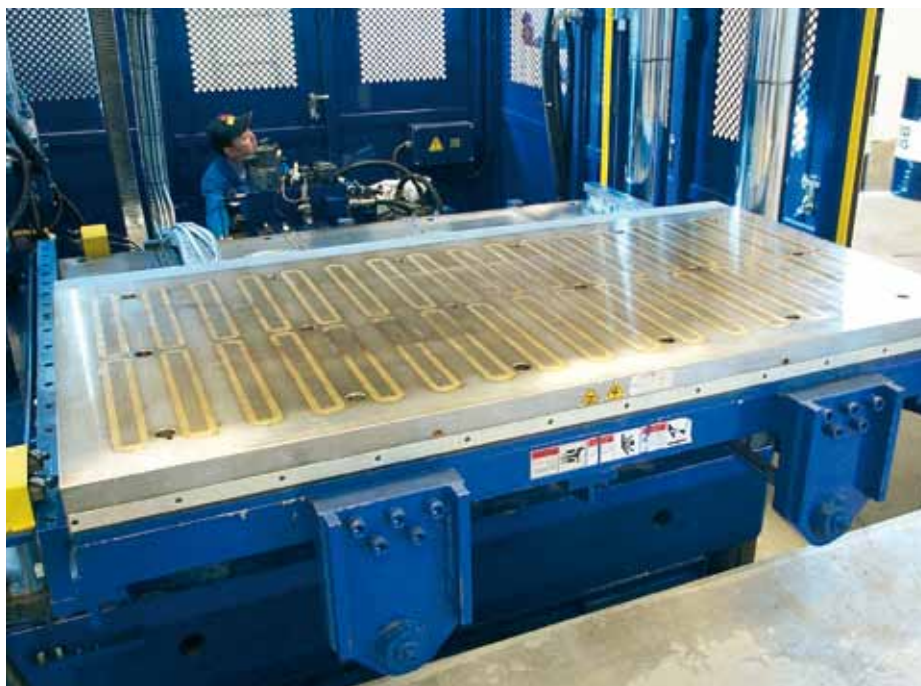
Magneet spansysteem op een verticale pers t.b.v. inzettemperaturen van 240 °C.
