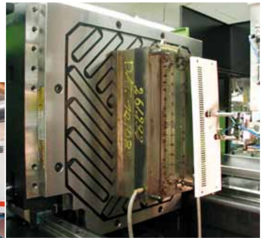
M-TECS 130-K – het M-TECS concentratie effect: de langpolen in dubbele magneettechniek leiden de magneetkracht in het gereedschap spanvlak.
